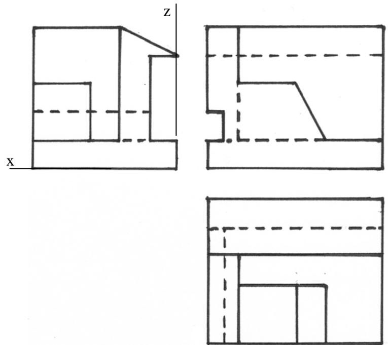
A4.- Completar la representación de la figura con la tercera vista, a partir de las dos vistas proporcionadas: alzado y perfil izquierdo.
